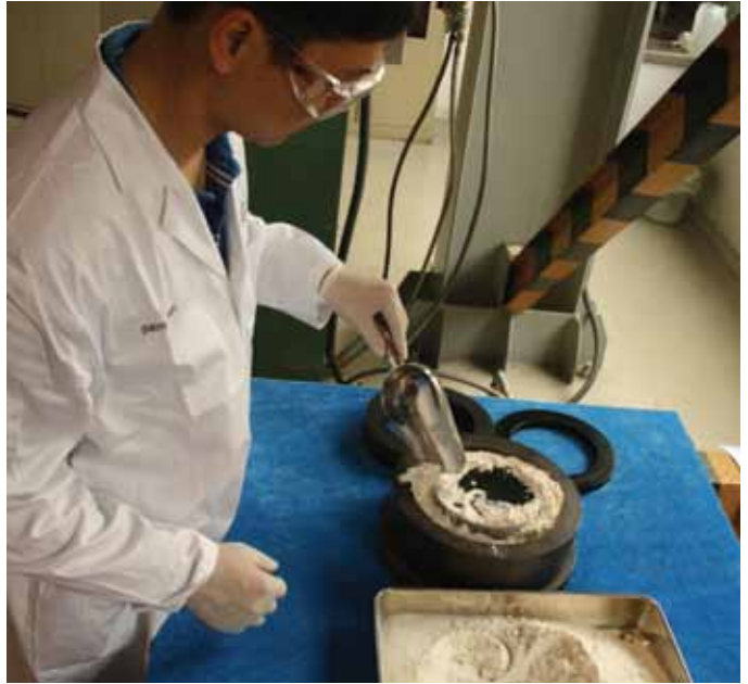
깨끗하게 세척한 금형에 정확한 양의 빅트렉스 PEEK 분말을 조심스럽게 채워야 합니다.
